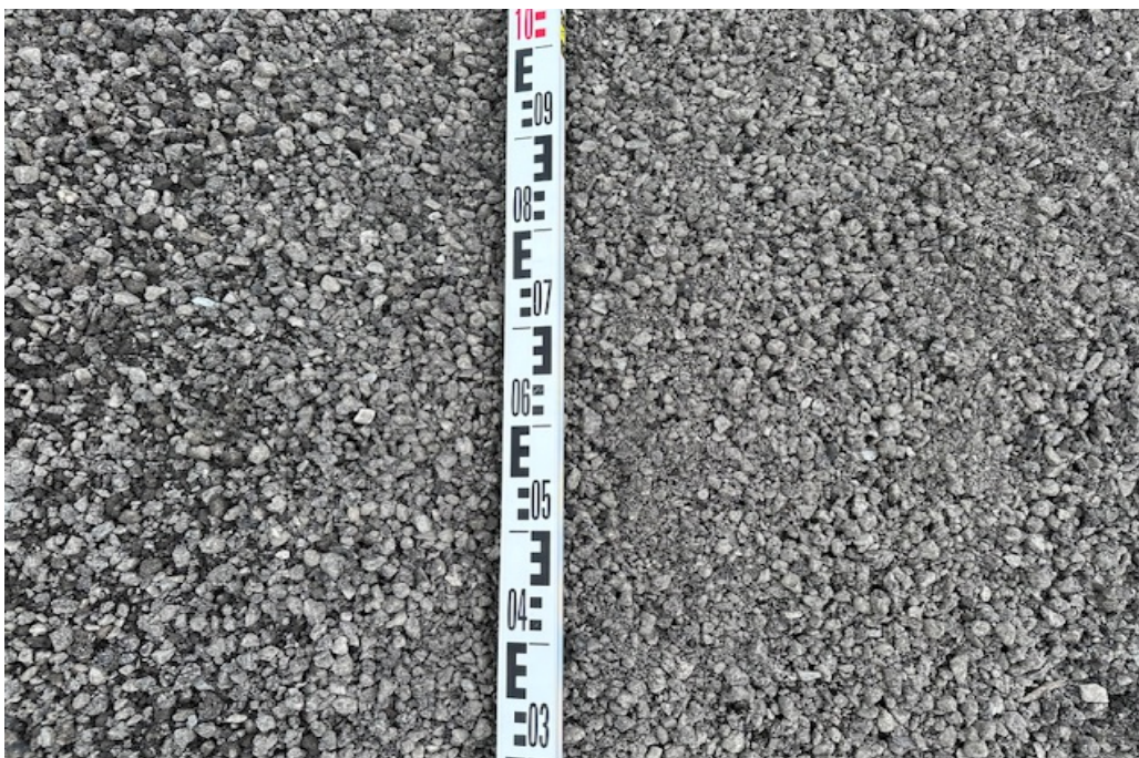
Foto 2: Detailaufnahme der recycelten Gesteinskörnung
